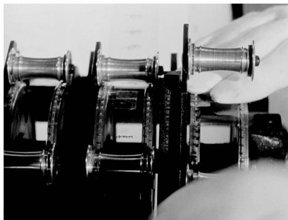
Illustration du fonctionnement de la synchroniseuse : chaque enrouleur accueille soit la bande image, soit la pellicule contenant les informations sonores, ce qui permet de les synchroniser. Voir la fiche.
