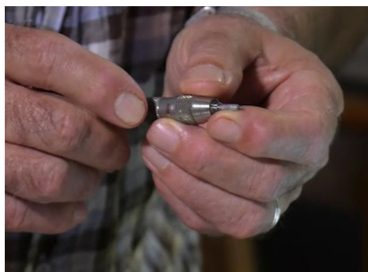
Pointe au carbure utilisée par Pierre Hébert pour graver ses dessins sur la pellicule opaque. Voir la fiche.
